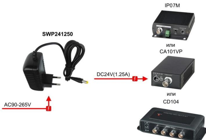
Рис.3 Типовая схема подключения блоков питания на примере SWP241250
